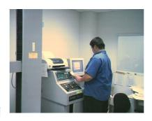
20 順萬能試驗機,進行螺絲拉拔試驗,
